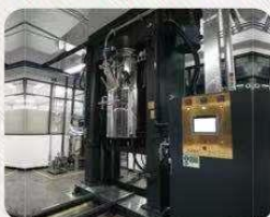
带全自动投料系统的搅拌机,客户使用现场
